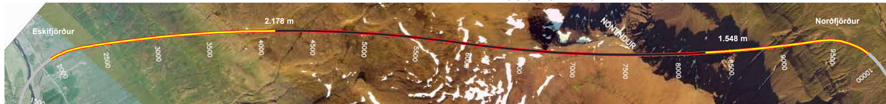
Norðfjarðargöng, staða framkvæmda 13. október 2014. Búið er að sprengja samtals 3.726 m sem er 49,2% af heildarlengd.
