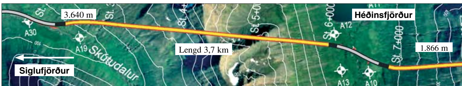
Staða framkvæmda við Héðinsfjarðargöng 26. jan. 2009. Sprengingum frá Siglufirði til Héðinsfjarðar lauk 21. mars 2008.
