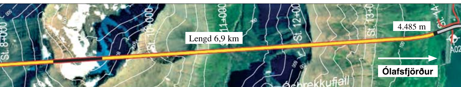
Búið er að sprengja 1.815 m í Héðinsfirði og 4.485 m í Ólafsfirði. Samtals 9.940 m sem er 94 % af heildarlengd.
