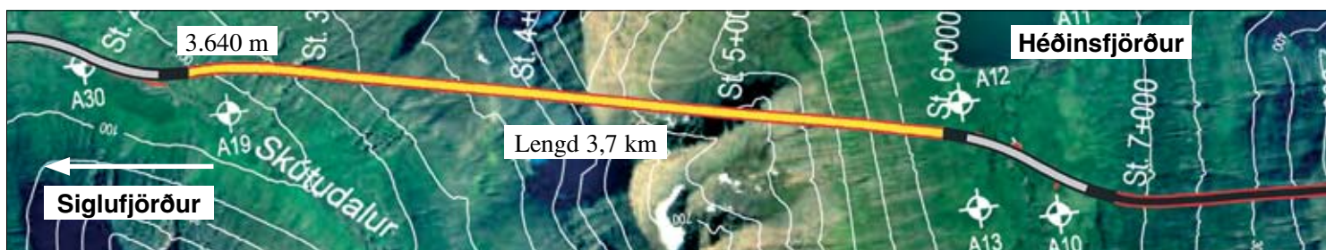
Staða framkvæmda við Hédinsfjarðargöng 31. mars. 2008. Búið er að sprengja 3.640 m í Siglufirði og 2.712 m í Ólafsfirði.
