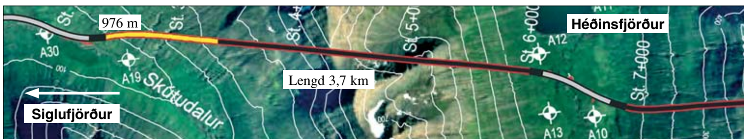
Staða framkvæmda við Héðinsfjarðargöng 26. febrúar 2007. Búið er að sprengja 976 m í Siglufirði og 740 m í Ólafsfirði.
