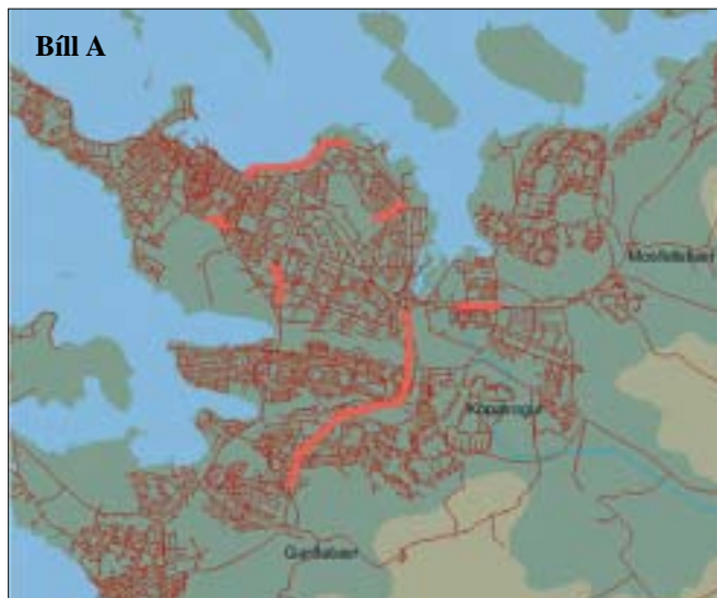
Samanburður á aksturslagi tveggja ökumanna í beygjum. Beygjuálag vegur þungt á sliti dekkja og stýrisbúnaðar og eykur líkur á stjórnleysi bifreiðarinnar. (24 faldur munur!).
