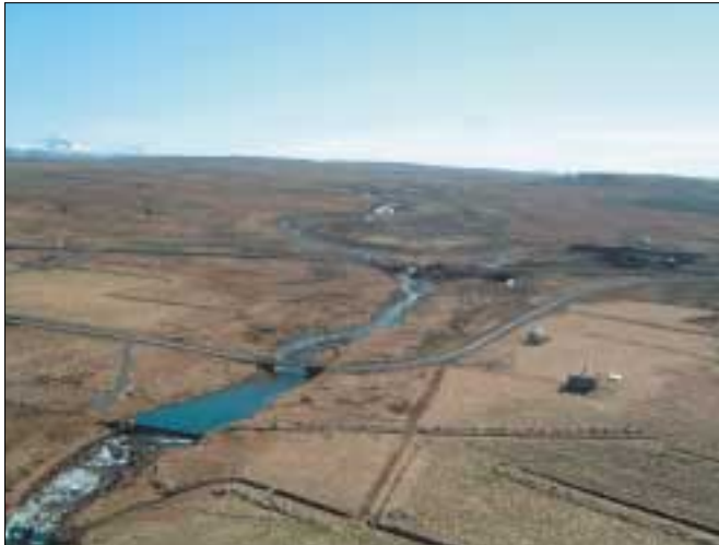
Norðausturvegur (85). Hólkur settur í Saurbæjará í Finnafirði og veglína lagfærð. Myndir: Viðir Gíslason, 24. maí 2004.
