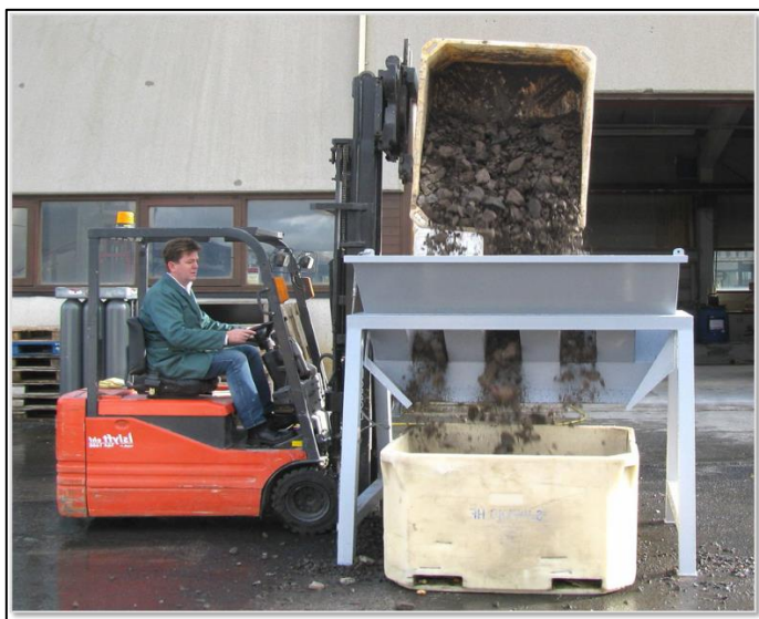
Mynd 10: Grófgerðu sýni úr fiskikeri skipt í stóru riffluboxi
