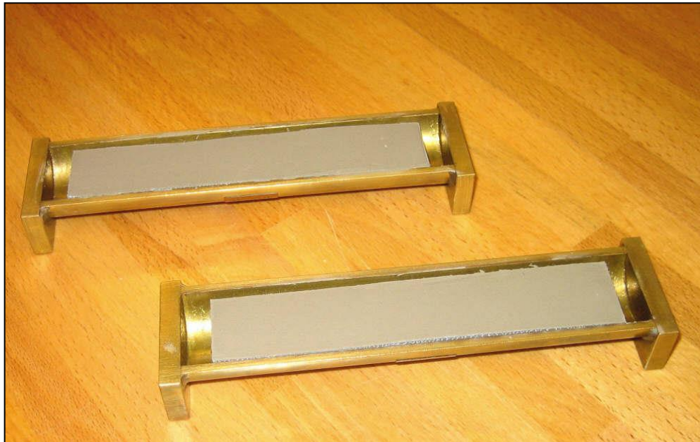
Mynd 22. Ljósmynd af sýni í móti við mælingu á þurrkrýrnun fínefna
