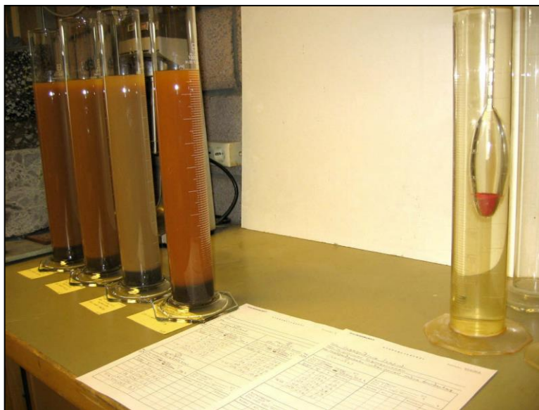
Mynd 5. Ljósmynd af hydrometer tækjabúnaði
