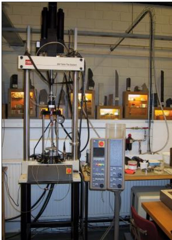
Mynd 59. Stöðuálagspróf, þríásatæki
