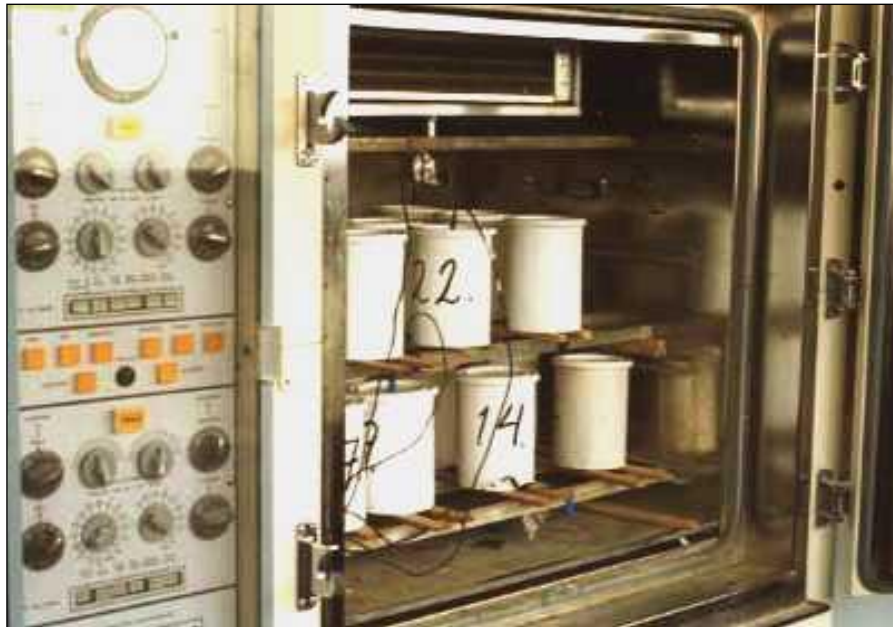
Mynd 45. Frost/þíðu skápur með sýnadósum
