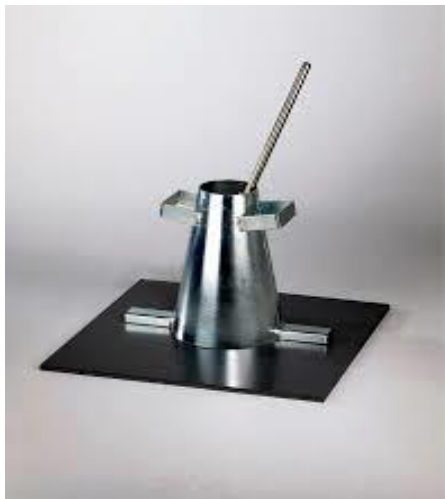
Mynd 82. Keila til að mæla sigmál ferskrar steypu
