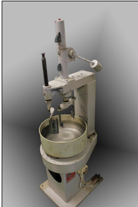
Mynd 46. Hrærivél sem notuð er við prófun á viðloðun með hrærsluprófi
