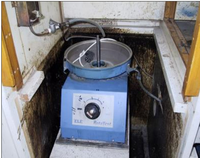
Mynd 74. Dæmigerð skilvinda til mælingar á bindiefnisinnihaldi
