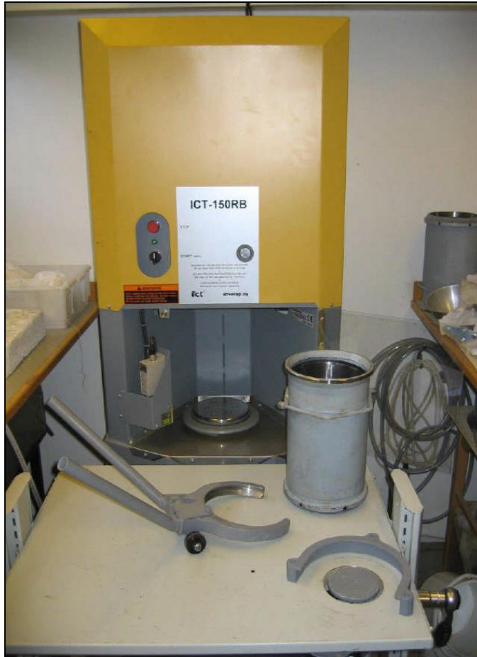
Mynd 76. Tækjabúnaður til hnoðþjöppunar
