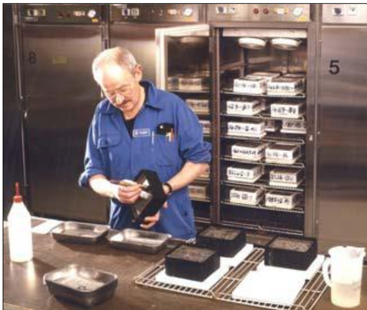
Mynd 85. Frostþolspróf á steinsteypu, það sem flagnar við áraun er skolað og burstað frá
