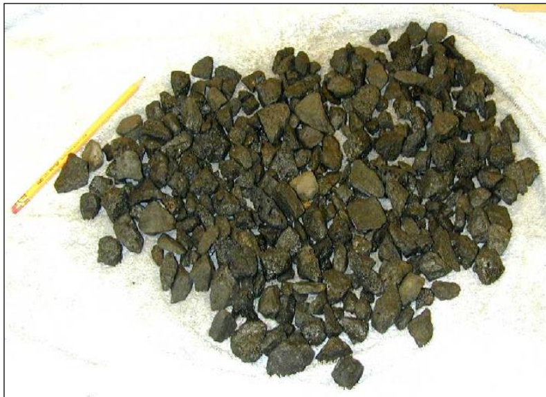
Mynd 25. Vatnsmettað og yfirborðsperrað sýni
