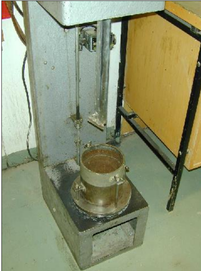
Mynd 40. Proctor hamar notaður til þjöppunar á sýni í Bg-próf
