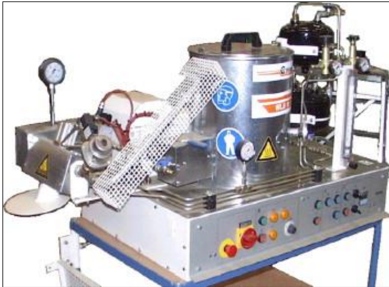
Mynd 86. Tæki til að framleiða froðubik á rannsóknastofu
