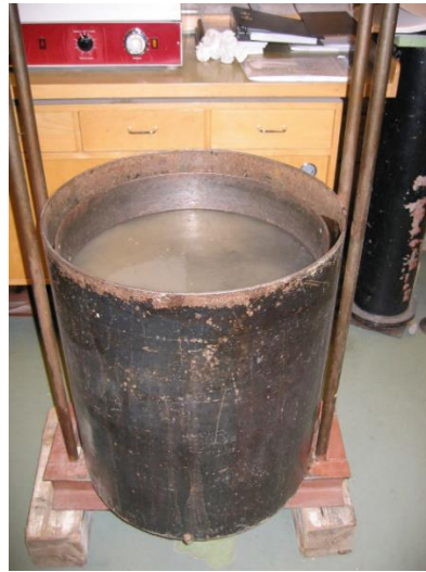
b) Efnið vatnsmettað eftir þjöppun.
