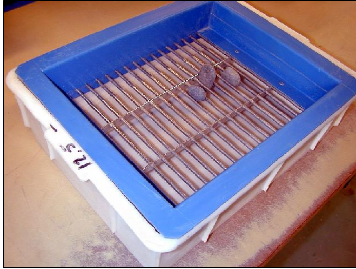
Mynd 32. Stafsigti til mælingar á kleyfnistuðli
