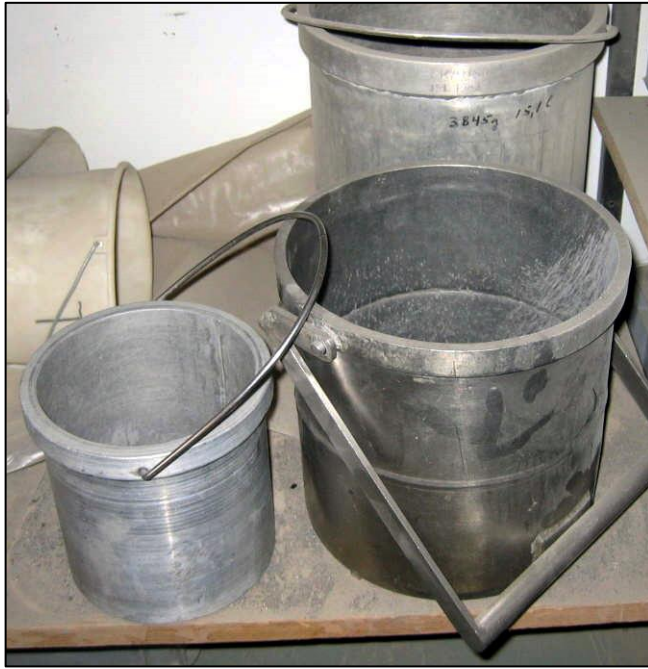
Mynd 26. Mót til mælinga á lausri rúmpýngd
