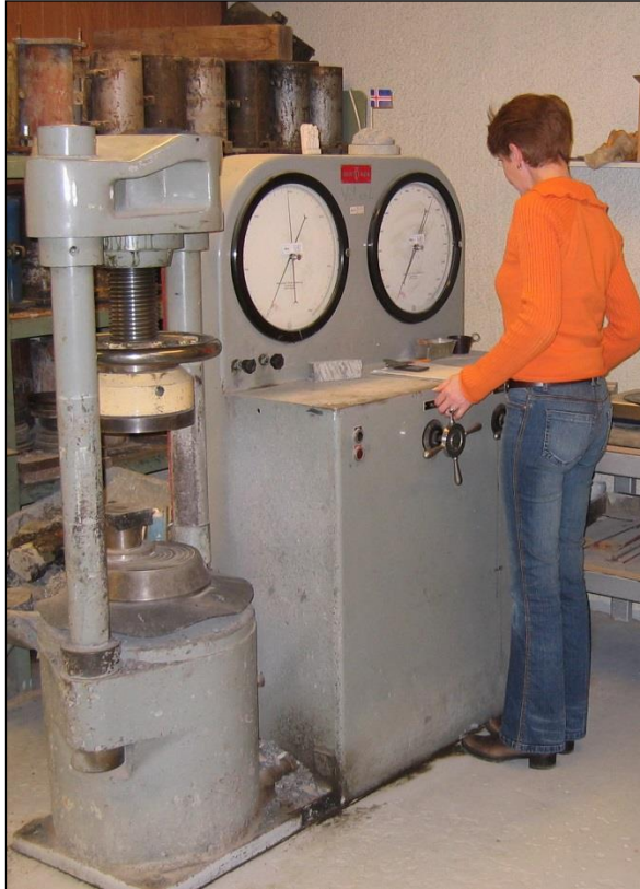
Mynd 83. Dæmi um pressu sem notuð er til að mæla brotstyrk steypusívalninga
