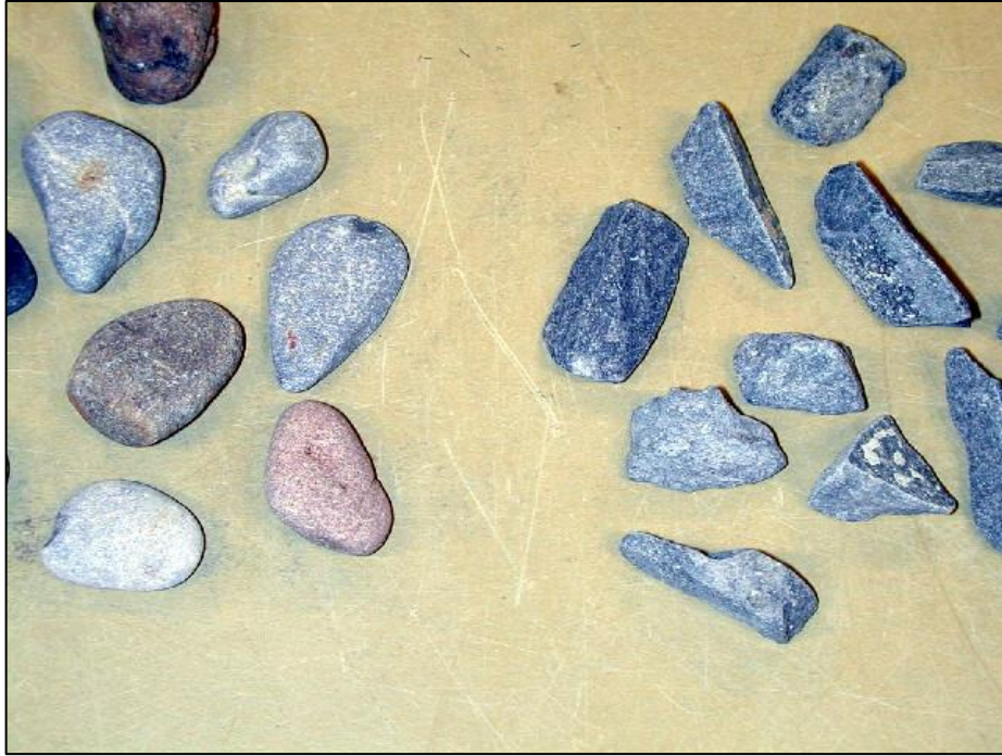
Mynd 36. Brothlutfall steinefna, núin og óbrotin korn vinstra megin og brotin hægra megin
