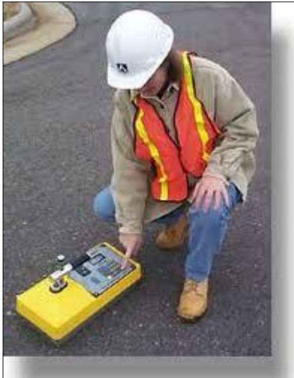
Mynd 66. Geislaæli til mælingar á rúmpýngd/þjöppun
