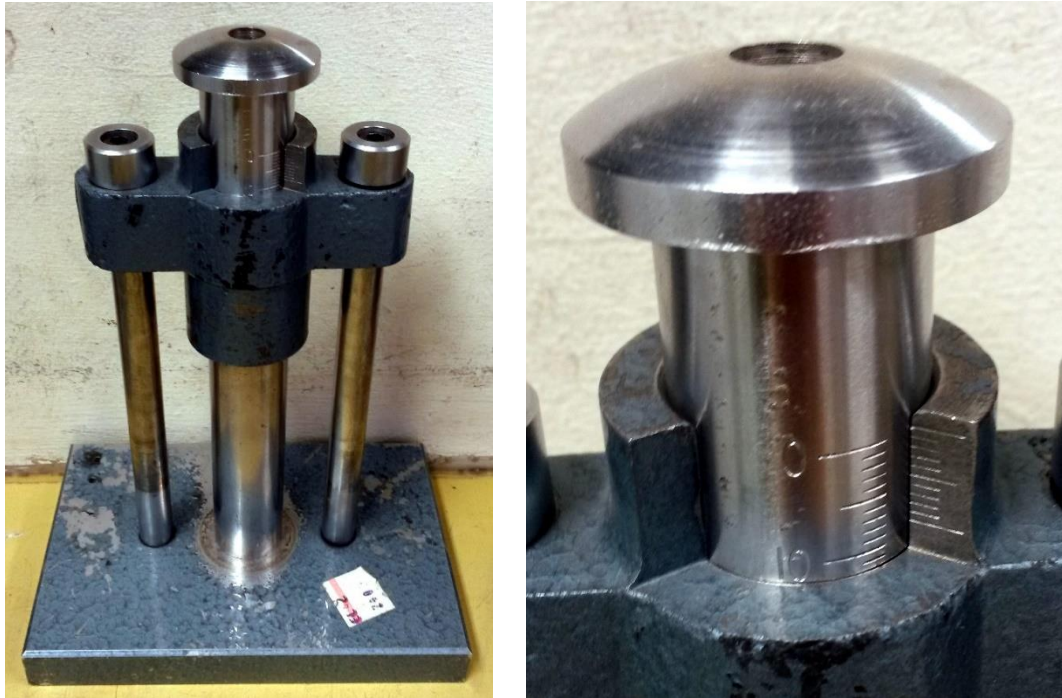
Mynd 14 a) og b). Búnaður til að mæla Rigden holrýmd mélu
