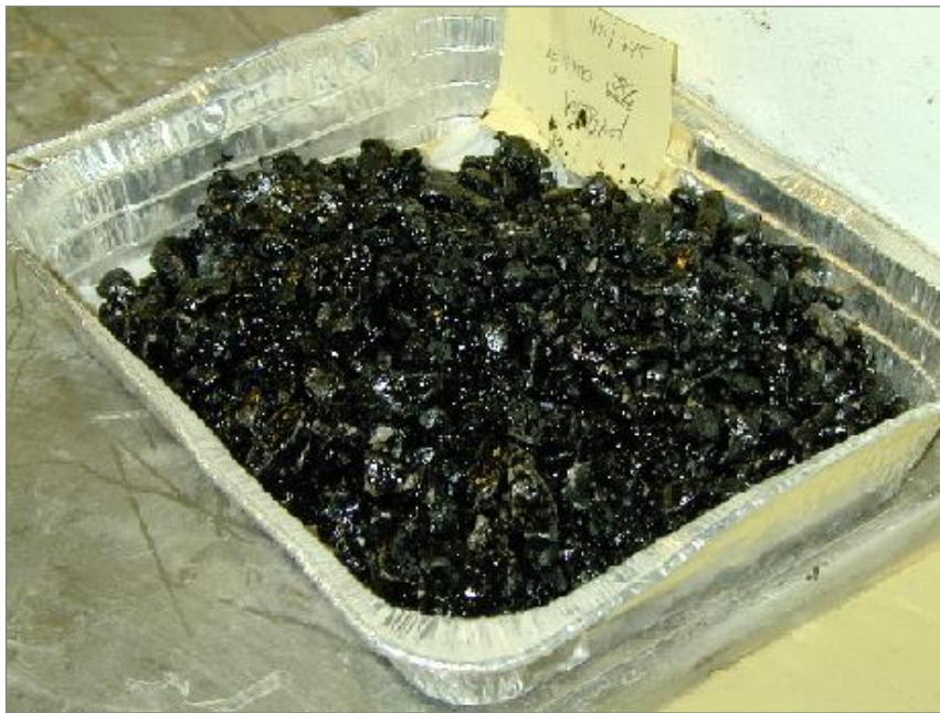
Mynd 47. Sýni úr hrærsluprófi, þakning mikil
