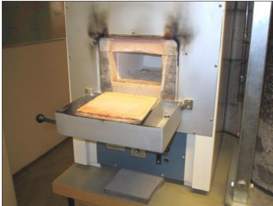
Mynd 9. Ofn til að hita sýni til glæðitapsmælingar
