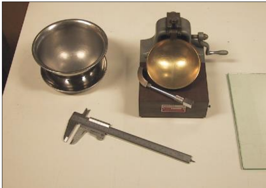
Mynd 20. Tæki til mælingar á flæðimarki
