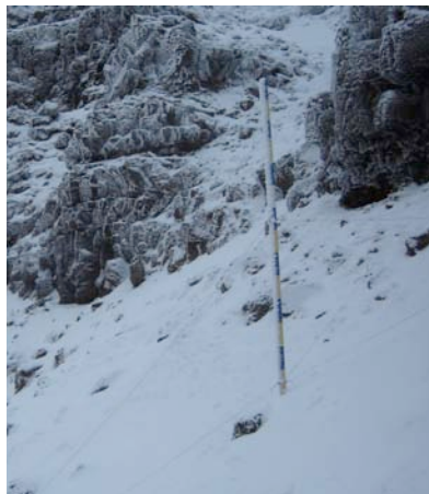
Mynd 2: Snjóstíkur með kvarða eru hefðbundinn búnaður til snjódýptarmælinga í fjallendi.
