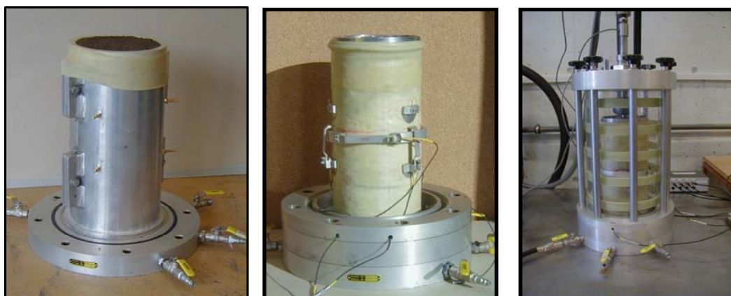
Mynd 5. Þríásapróf, a) full þjappað sýni í stálhólki, sjá má ankeri standa út úr stálhólknum b) sýni með áfasta mælinema, c) sýni í prófun í þríásahúsi.
