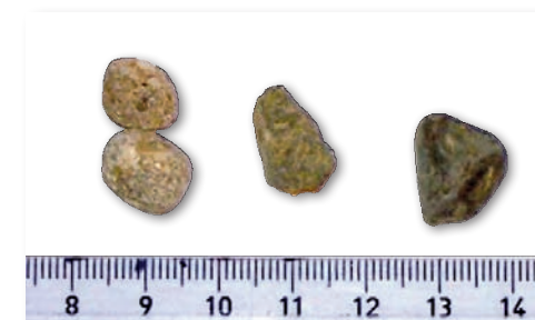
Mikið ummyndað basalt til vinstri, ummyndað basalt og svo ferskt/lítillaga ummyndað basalt til hægri.
