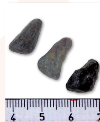
Ferskt/lítilliga ummyndað, þétt basalt efst, ummyndað og þétt basalt í miðjunni og basaltgler neðst.
