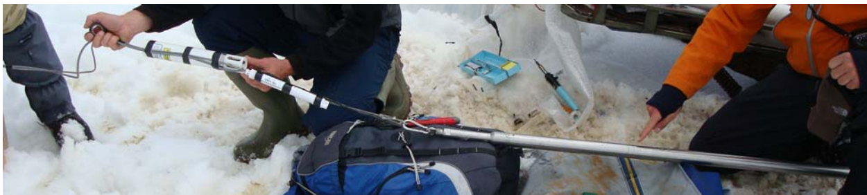
9. mynd. Tveir hitanemar með innbyggðu minni festir á kapal, sem tengdur er við sýnataka.
