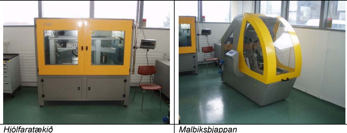
Mynd 2.1: Hjólfaratæki frá Controls á Nýsköpunarmiðstöð
