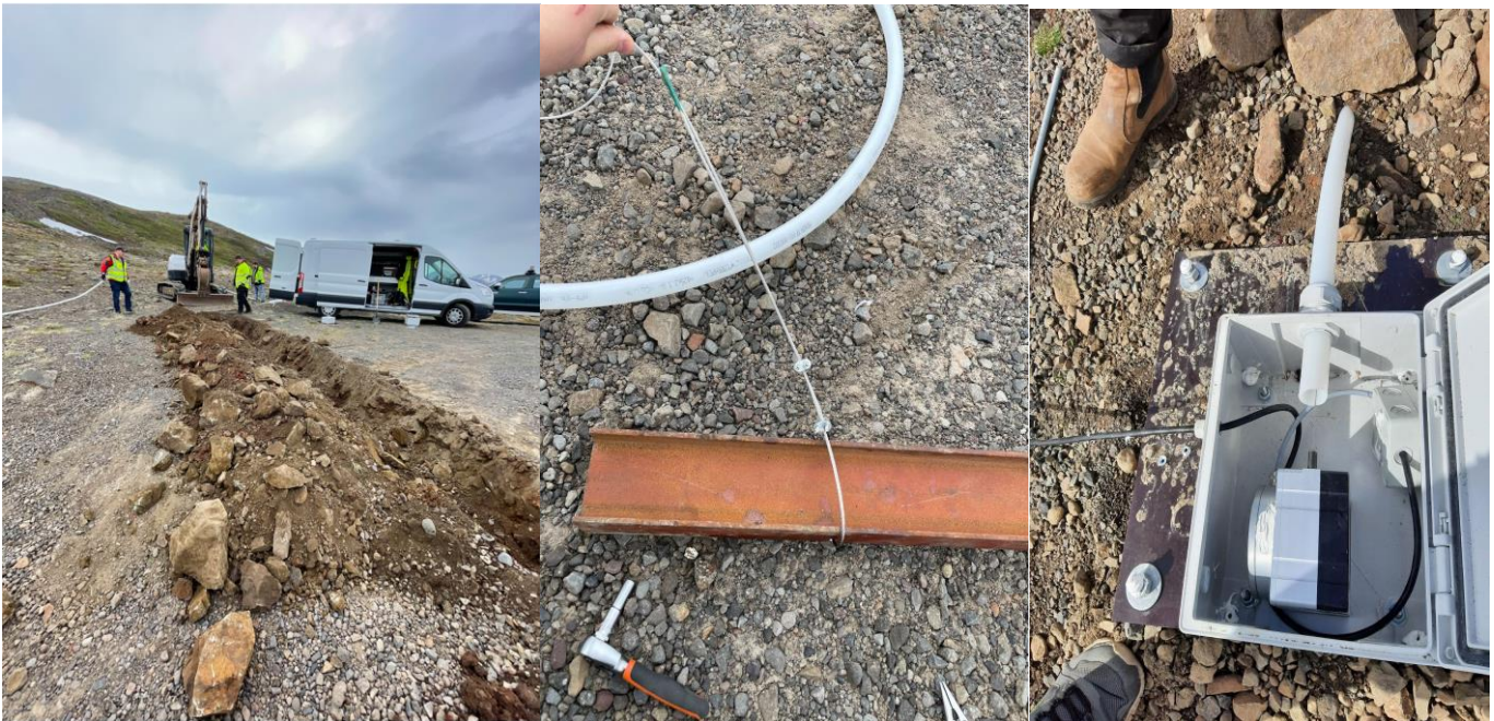
Skurður gerður í veginn / Vírinn festur í stálakkeri / Mælir í tengiboxi með útdregnum vír
