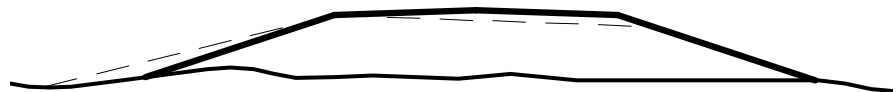
Mynd 2.10 Nauðsynlegt er að fletja út fláa þegar þverhallabreyting verður á vegi á leið inni í beygju.
