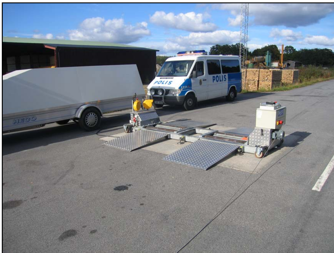
Mynd 8. Laus bremsuprófunarbúnaður á steyptri plötu á eftirlitsstað í Hurva við E22 í Svipjóð (Ljósmynd, Sævar Ingi Jónsson).
