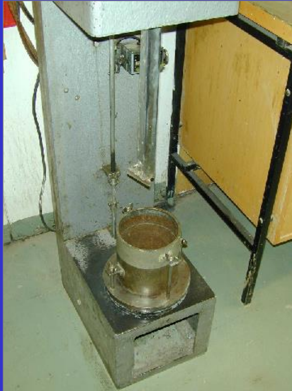
Proctor hamar notaður til þjöppunar á sýni í Bg próf
