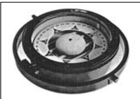
Seguláttaviti í ramböldum. Á ytra borði hringins eru tveir tappar gagnstætt hvor öðrum sem hvíla í legum í kompáshúsinu. Kompásskálinn er í legum innan á hringnum. Þessi útbúnaður er til þess að kompásinn og þar með kompásrósinn haldist nærri því lárétt þrátt fyrir velting og stamp skipsins.
