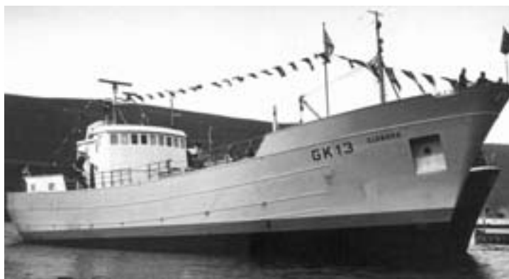
M.s. Eldborg GK-13. Eldborg var fyrsta íslenska fiskiskipið með millipilfari, þ.e. skjólpilfar var yfir aðalpilfarinu í stað þess sem þá var algengast að aðalpilfarið væri opið milli brúar og hvalbaks. Þannig fékkst skjólgott vinnupilfar og auk þess mun meira fríborð og þar með aukið öryggi. Hjálmar R. Bárðarson, teiknaði skipið og tók myndina við sjósetningu 22. júlí 1967.
