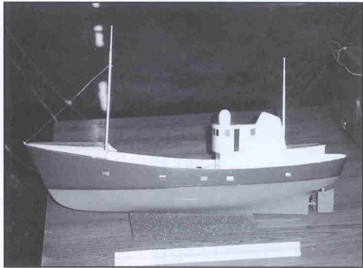
Líkan af vertíðarbáti sem er notað í rannsóknarverkefni um stöðugleika fiskiskipa.
