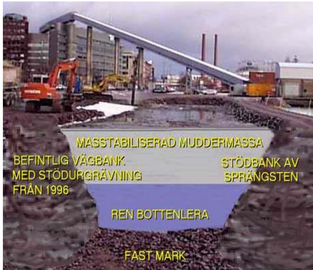
Strandkonstruktion för Sörnäs strand
