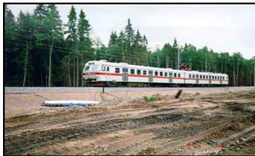
JÄRNVÄGSTRAFIK PÅ STABILISERAD TORV
