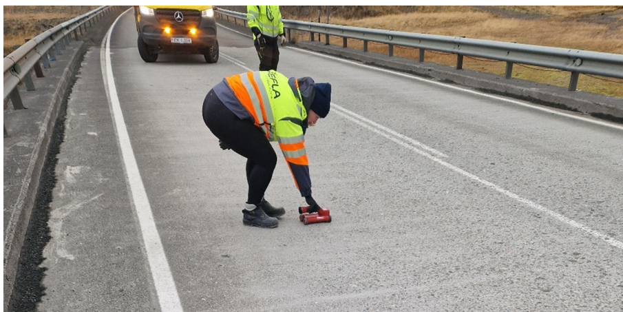
MYND 4.4 Steypuhula á járn mælt með járnaskanna. Mynd frá mælingu á brúargólfi á brú á Norðurá.
