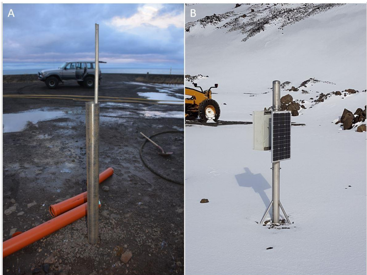
Mynd 6. A. Coaxial kapallinn var látinn stand um 2 m upp úr borholunni. B. Gengið var frá borholunni og komið fyrir mælaboxi og sólar sellu.
