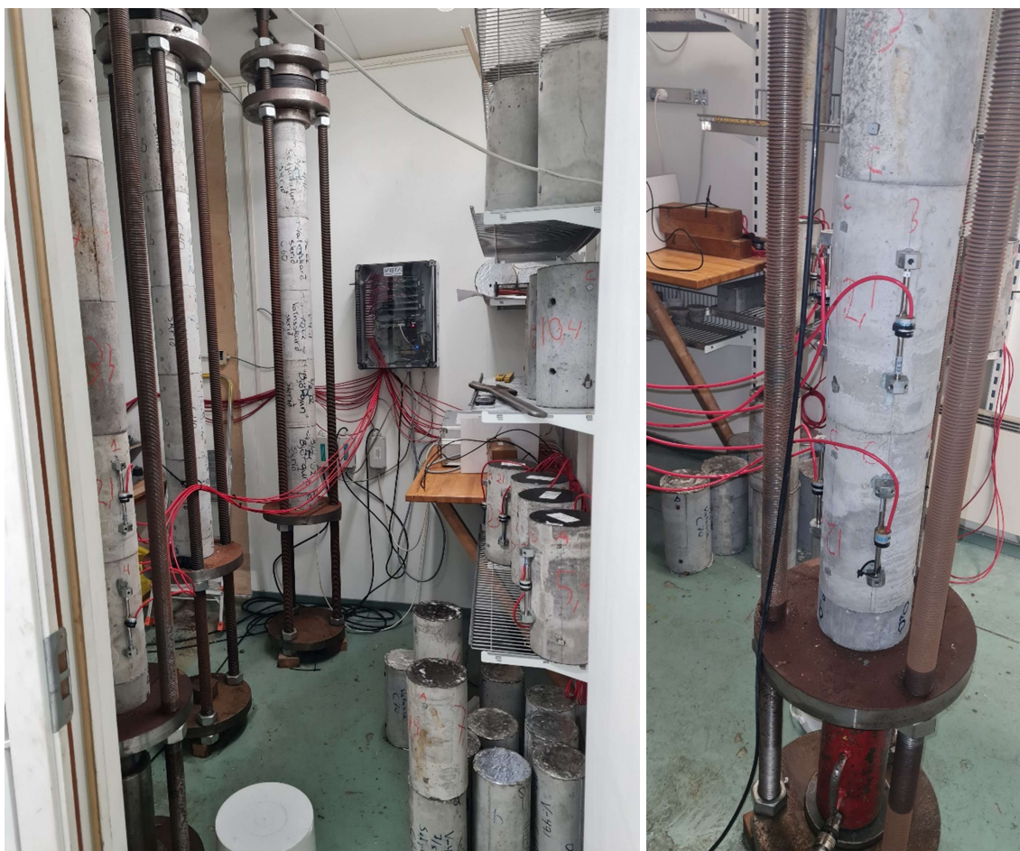
Mynd 1. Skriðrekkar. Á myndinni t.v. má sjá skriðrekkana þar sem sjá má streitunema. Streitunemana má einnig sjá á myndinni t.h. Sívalningarnir sem standa í hillunum hægra megin á myndinni t.v. er sívalningarnir sem voru notaðir í rýrnunarmælingar. Sjá má að endar rýrnunarsívalningana eru með tjöruborða.
