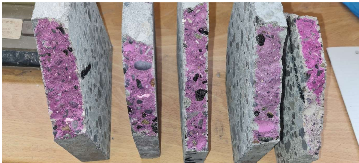
Mynd 32. Kolsýring brúarsteypusýnanna. Sýnin eru frá vinstri til hægri: Vg 3-4, Vg 5-6, Vg 7-8, Vg 9-10 og Vg 11-13. Sjá má kolsýringu í yfirborði sýnanna sem ólitaða steypu.
