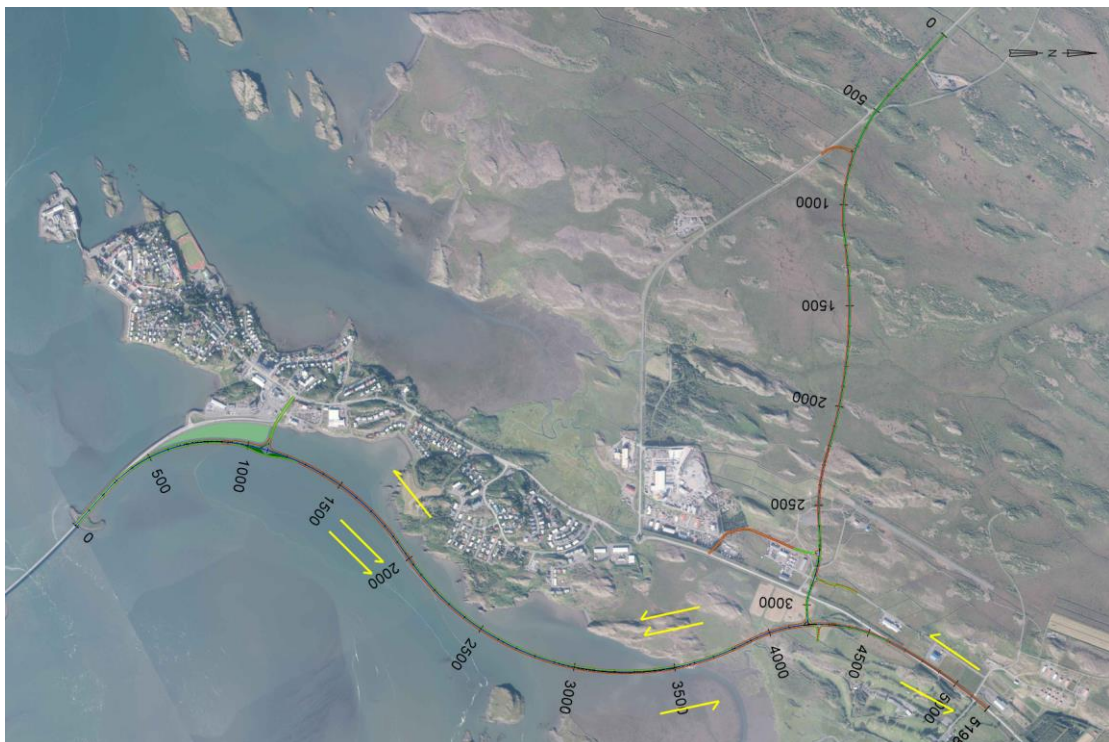
Mynd 17: Yfirlitsmynd af tillögu 5 fyrir Hringveg og Snæfellsnesveg. Gulu örvarnar sýna fjölda akreina í akstursstefnu.
