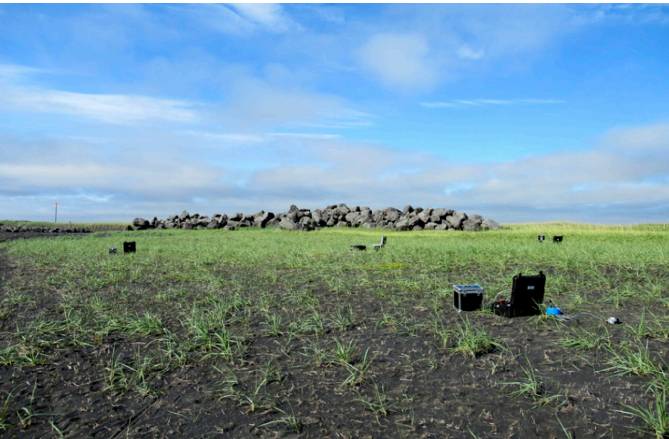
↑ Frá framkvæmd passífar yfirborðsbylgjumælingar í Bakkafjöru.
