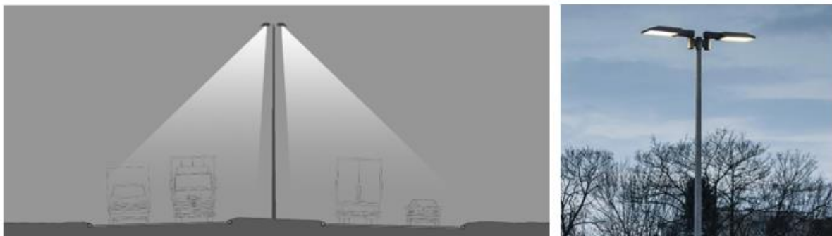
Mynd 7-2 – Veglýsing fyrir utan gangamuna
