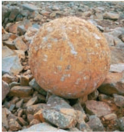
Mynd 8.8: Stálkúla sem notuð er til að brjóta stórgryti í nýtanlegar stærðir.
