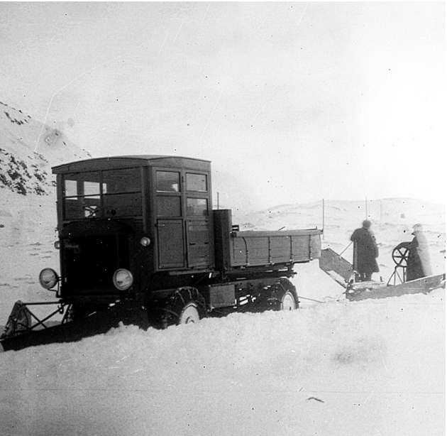
↑ Snjómokstur í Hveradalabrekku þar sem plógur er festur aftan við bíl og minni plógur að framan. Þrjá menn þurfti að stýra tækinu. Einn ók bílnum, annar stýrði plógnum að aftan og sá þriðji sat á fremri plógnum til að þyngja hann. Mynd: Geir G. Zoëga
