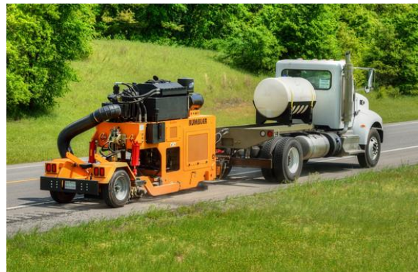
MYND 13 Til vinstri: Vegmerkingar málaðar í botn sínuslaga vegriffa [15, mynd 1.5]. Til hægri: Fræsari fyrir vegriffur (e. rumble strip grinder), sótt af http://www.roadproonline.com/rumbler.html .
