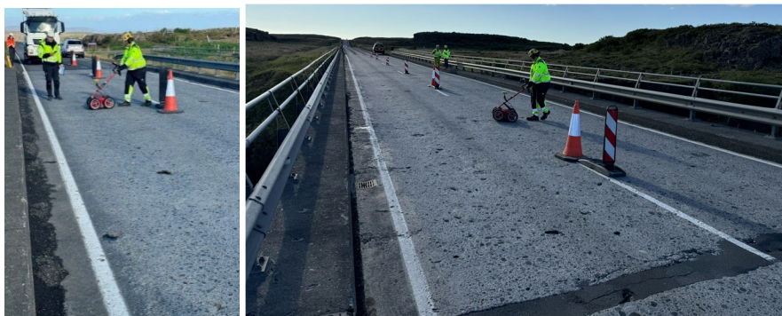
Mynd 20 – Mælingar með göngujarðsjá á Gljúfúrabrú.
