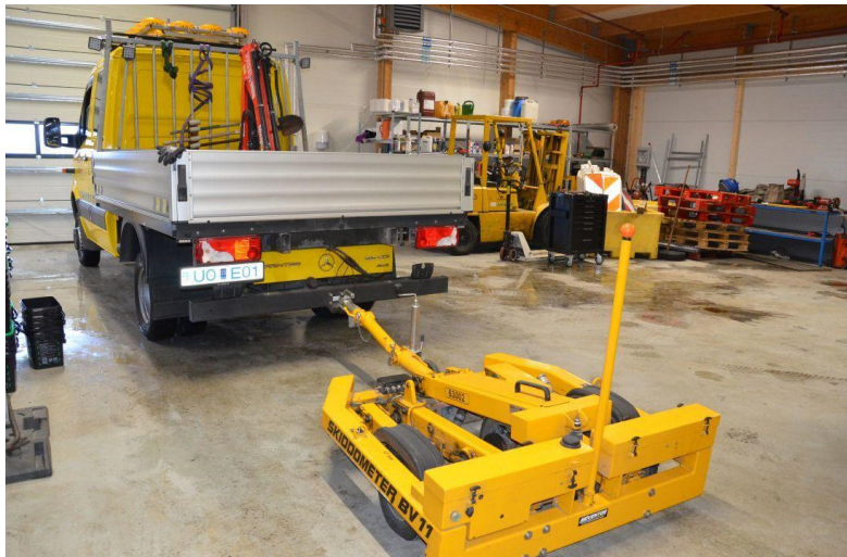
Mynd 7 – Veggripsmælir Vegagerðarinnar (Vegagerðin, 2022).
