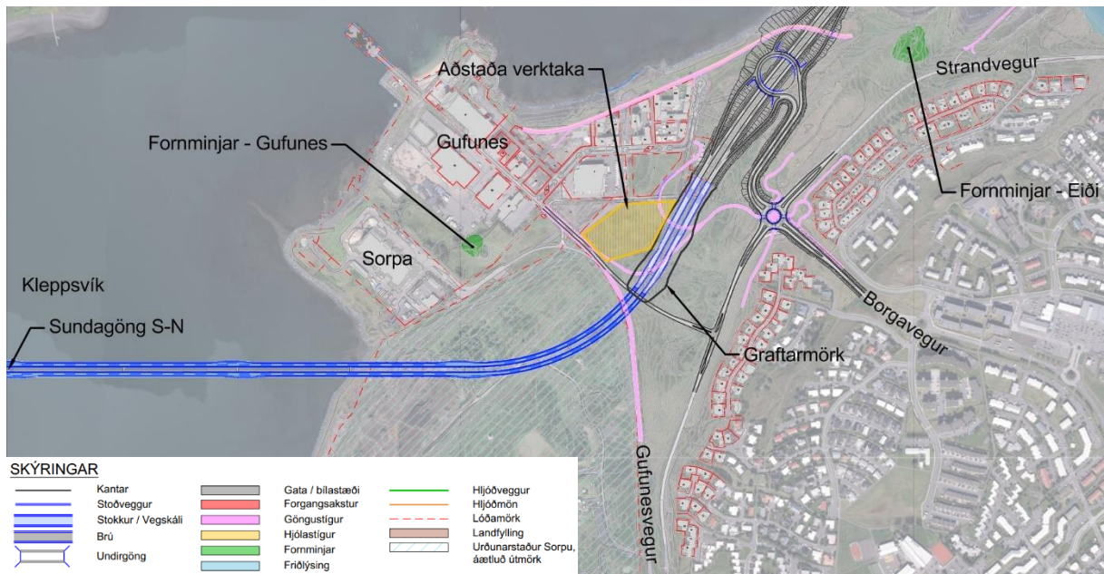
MYND 3.16 Norðurendi Sundaganga í Gufunesi. Á myndinni sjást gatnamót við Borgaveg ásamt stígatengingum. Sjá ítarlegri mynd í teikningahefti. Teikning: EFLA, 2025.
