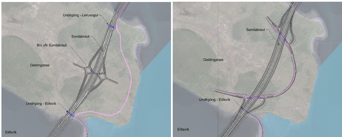
MYND 3.40 Mismunandi útfærslur gatnamóta á Geldinganesi. Teikning: EFLA, 2025.
