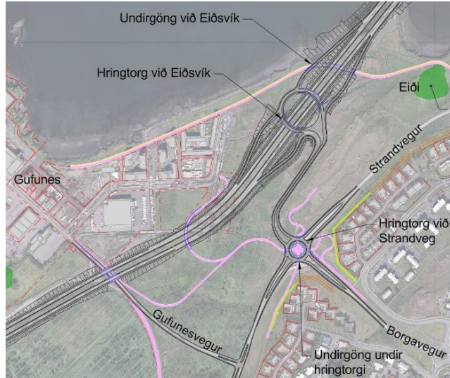
MYND 3.35 Gatnamót Sundabrautar við Strandveg/Borgaveg og Gufunesveg. Til vinstri er valkostur BG1 en til hægri er valkostur BG2. Teikningar: EFLA, 2025.
