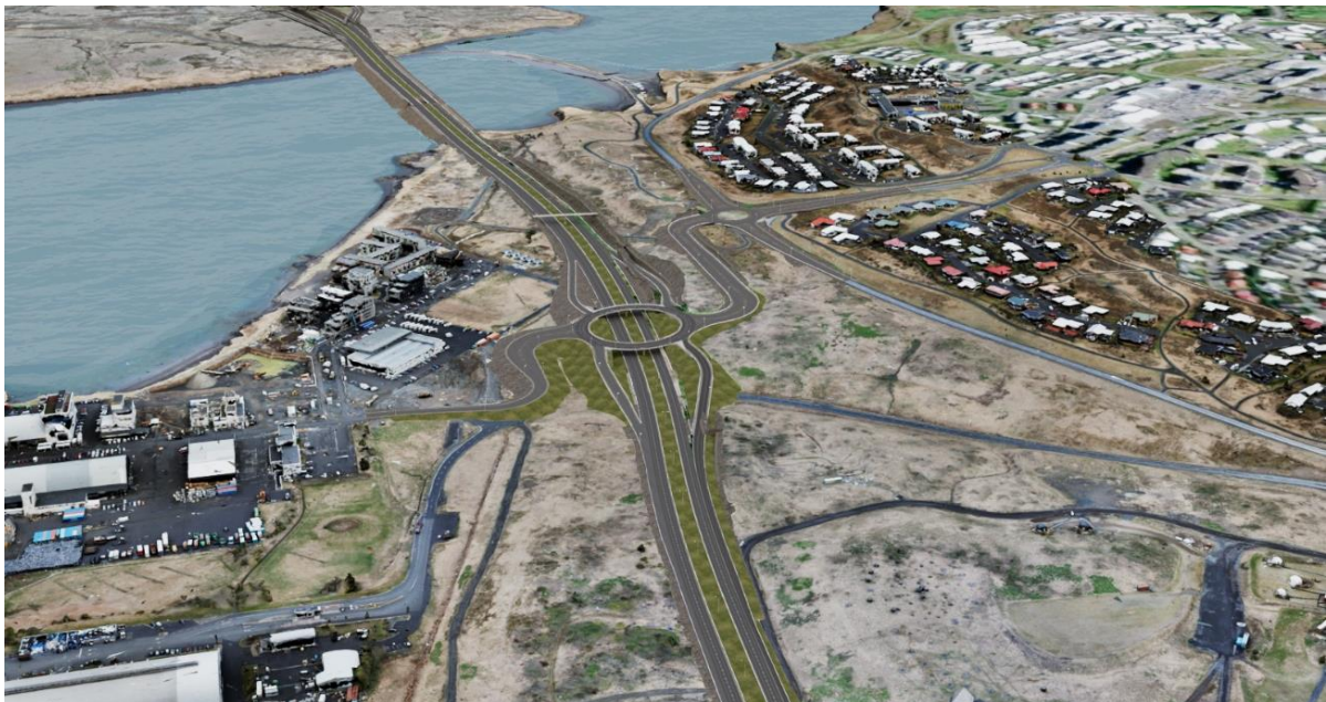
MYND 3.36 Líkan sem sýnir útfærslu gatnamóta Sundabrautar við Strandveg/Borgaveg og Gufunesveg fyrir valkost BG1. Mynd: EFLA, 2025.
