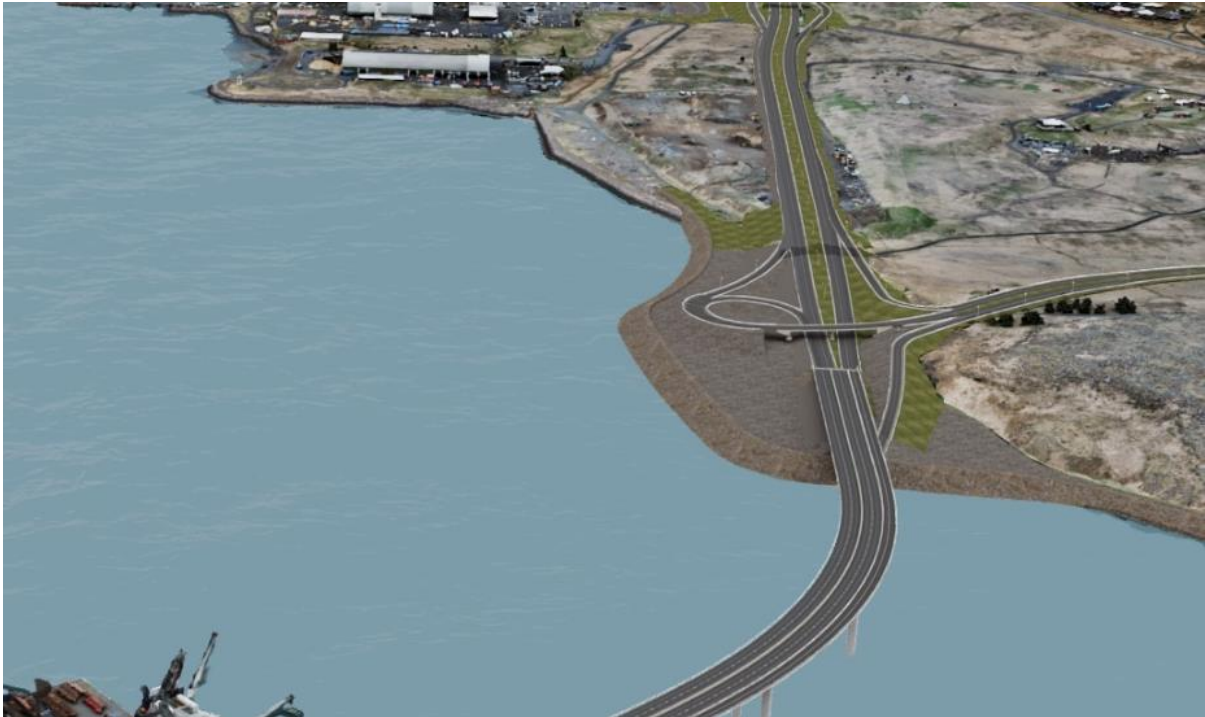
MYND 3.28 Líkan sem sýnir útfærslu fyllingar og gatnamóta við Hallsveg fyrir valkost BG1, neðan við Gufuneshöfða. Mynd: EFLA, 2025.
