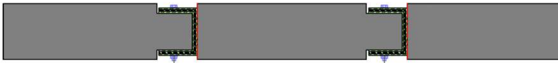
Mynd 17: Skerbrot við samskeyti steypu og stálskúffu
