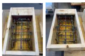
Mynd 5. Smíði á nýju tengingunni í 37,5% skala
