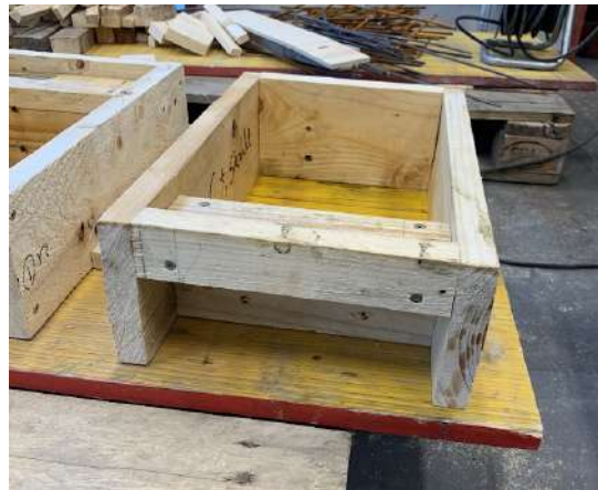
Mynd 22: Horft inn í enda U-lykkjumóts
