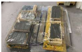
Mynd 6. Prófstykkin steipt
