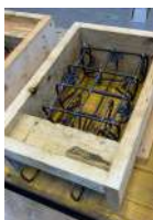
Mynd 3. Smíði á U-lykkju tengingu í 37,5% skala
