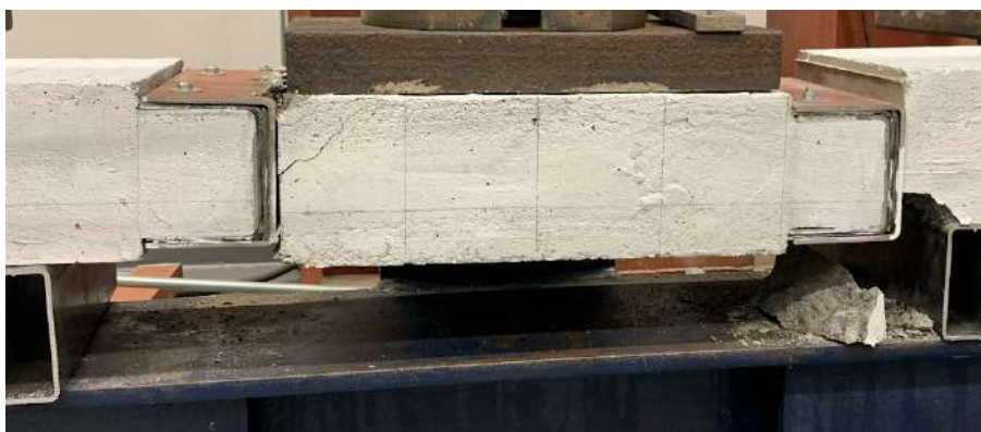
Mynd 41: Prófstykki með skúffutengingum eftir prófun
