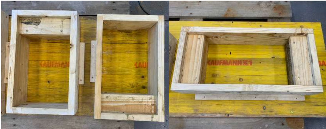
Mynd 21: Mót fyrir U-lykkjutenginguna
