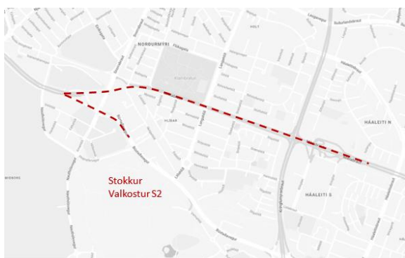
MYND 5-3 Yfirlit yfir þá valkosti sem fyrst voru skoðaðir fyrir Miklubraut í stokk. Heilar línur tákna rampa og tengingar ofanjarðar en brotalínur eru stokkalausnir.
