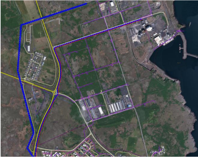
Mynd 13: Grunnmynd lagnaleiðar 220 kV strengja frá Garðskagavegi að ætluðu álveri og lagnaleiðar 132kV strengja meðfram Garðskagavegi og Stakksbraut. -
