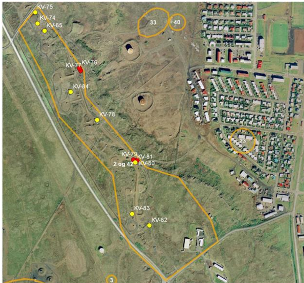
Mynd 3.1 Könnunarstaðir varðandi olíumengun á Efra-Nikelsvæði árið 2009. Rauðir punktar sýna staði þar sem olíuefni greindust en gulir þar sem engin lykt fannst og því ekki tekin sýni þar (Verkís, 2023).
