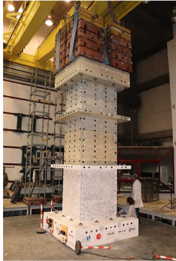
Mynd 3 – Uppsetning á blindtilraun í Portúgal, a) skematísk mynd og b) ljósmynd frá tilraun (ALL4wALL, 2024). Prófstykkið stendur á hristiborðinu og efst er búið að bæta við massa.
