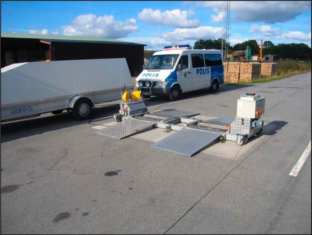
Mynd 8: Laus bremsuprófunarbúnaður á steyptri plötu á eftirlitsstað í Hurva við E22 í Svíþjóð (Ljósmynd, Sævar Ingi Jónsson).
