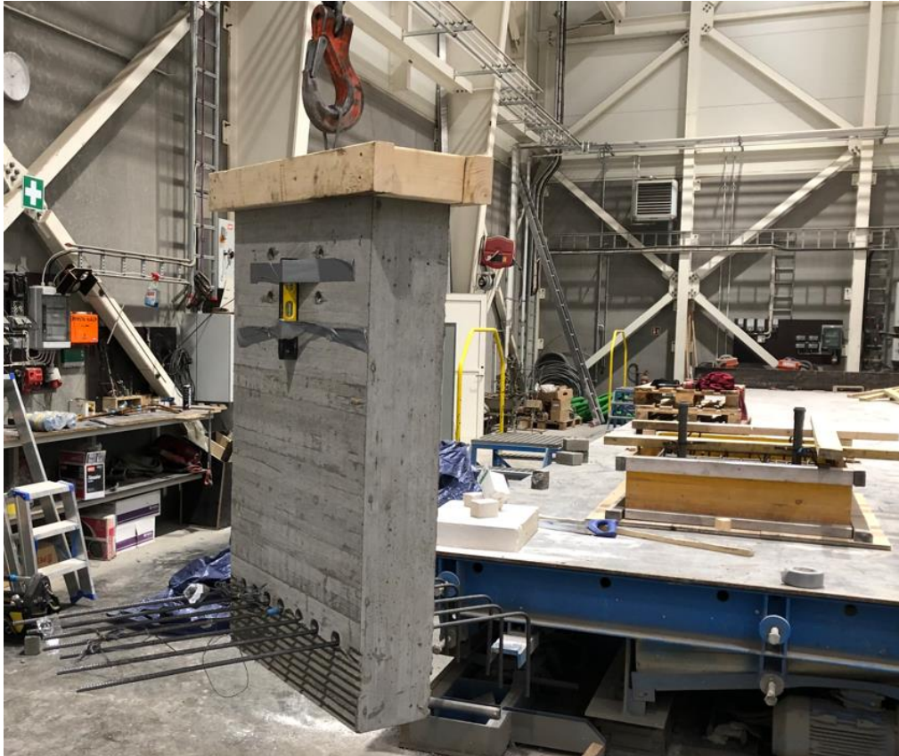
Mynd B 6: Stöpulveggur FSL-LS eftir að búið var að koma fyrir K10 járnum í gegnum göt. Verið er að hífa vegg ofan í steypumót sökkuls.
