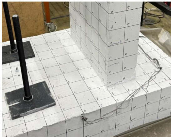
Mynd D 5: : FSL-SS eftir lotu 5 (hlutfallsfærsla 0,73%). Sprungur halda áfram að teygja sig á austur- og vesturhlið veggjar. Engar sjáanlegar skemmdir á sökkli.
