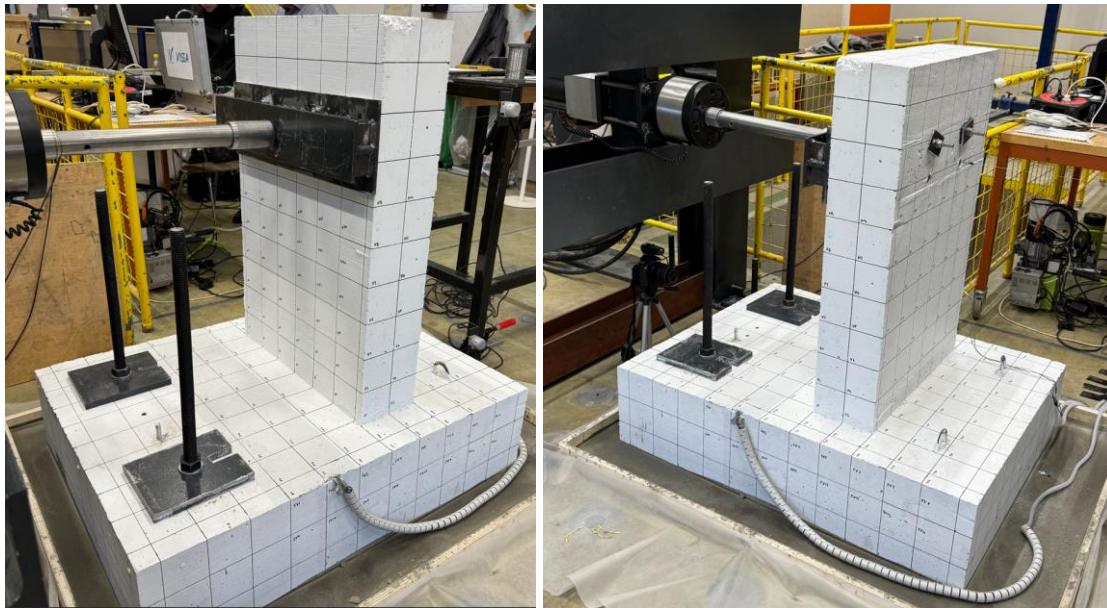
Mynd 4-6: Bakhlið og framhlið prófstykkis FSL-LS fyrir álagsprófun.
