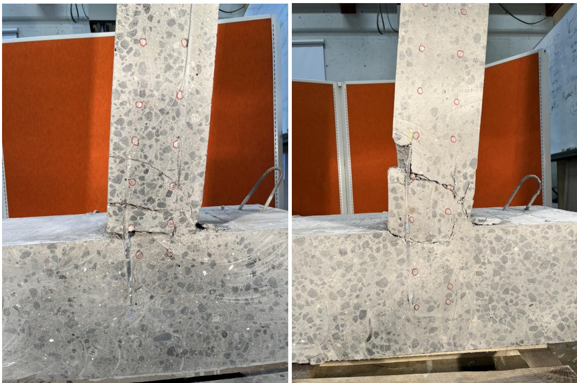
Mynd 1-8: Þverskurður prófstykkja -Staðsteypur landstöpull, SSL (vinstri) og forsteypur landsstöpull, FSL (hægri).
