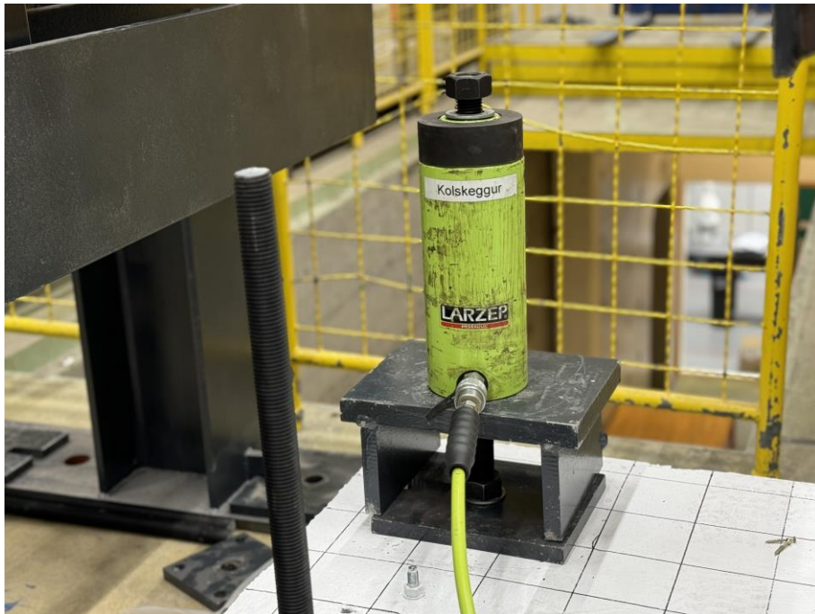
Mynd 3-3: Uppsetning vökvatjakks til að eftirspenna snittteina..
