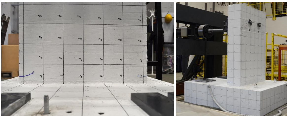
Mynd D 14: FSL-LS eftir lotu 2 (hlutfallsfærsla 0,14%). Hárfinar sprungur myndast á vegghornum norðurhliðar.
