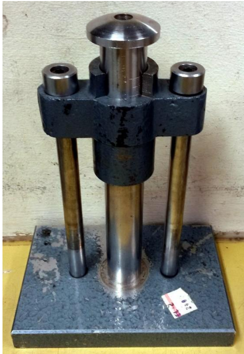
Mynd 3 a og b Búnaður til að mæla Rigden holrýmd fillers
