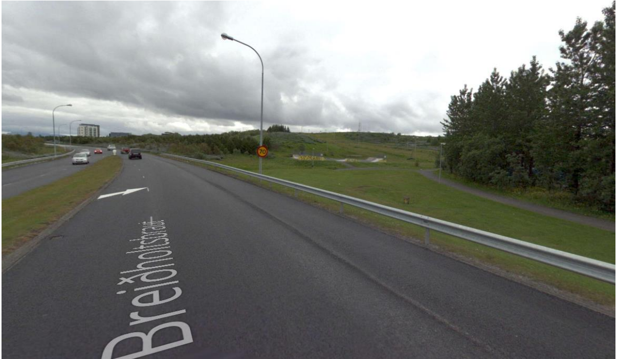
Núverandi bitavegrið við vegöxl Breiðholtsbrautar vestur af Jaðarseli sem þarf að færa/endurnýja (mynd af ja.is)
