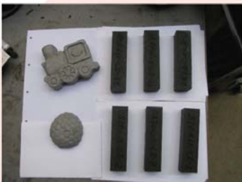
Steyptir múrstrendingar úr sementslausa eldfjallaöskusteinlímínu. Til vinstri má sjá lit á hefðbundinni steypu til samanburðar.
