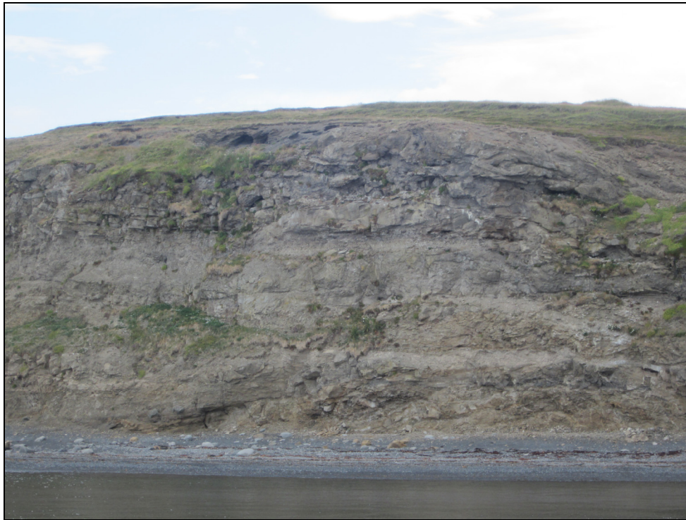
Ljósmynd 11. Bakkinn í fjörunni á móts við miðhluta vegskeringar við st. 1.700. Lagskipt og fremur brotið völuberg. Hæð bakkans er riflega 20 m.
