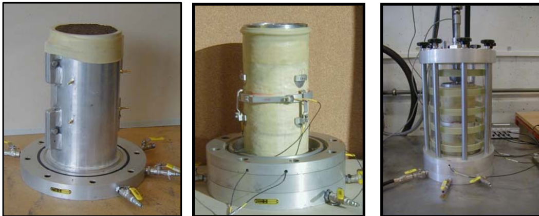
Mynd 4. Þríasapróf, a) fullþjappað sýni í stálhólki, sjá má ankeri standa út úr stálhólknunum b) sýni með áfasta mælinema, c) sýni í þrófun í þríasahúsi.
