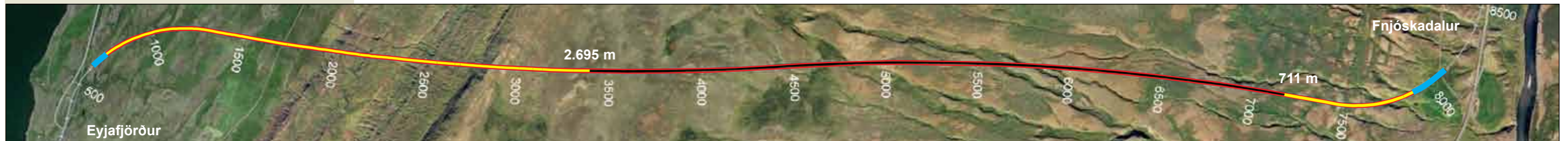
Vaðlaheiðargöng, staða framkvæmda 8. desember 2014. Búið er að sprengja samtals 3.406 m sem er 47,3% af heildarlengd.
