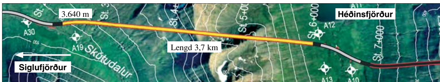
Staða framkvæmda við Héðinsfjarðargöng 5. maí. 2008. Sprengingum frá Siglufirði til Héðinsfjarðar lauk 21. mars 2008.
