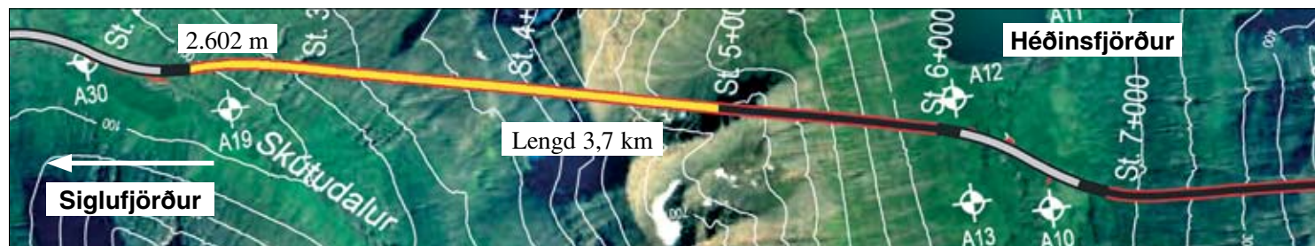
Staða framkvæmda við Héðinsfjarðargöng 8. okt. 2007. Búið er að sprengja 2.602 m í Siglufirði og 1.812 m í Ólafsfirði.
