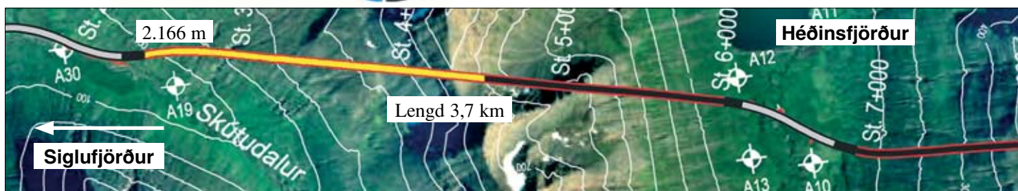
Staða framkvæmda við Héðinsfjarðargöng 20. ágúst 2007. Búið er að sprengja 2.166 m í Siglufirði og 1.791 m í Ólafsfirði.
