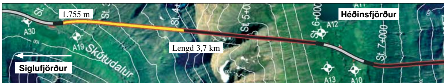
Staða framkvæmda við Héðinsfjarðargöng 29. maí 2007. Búið er að sprengja 1.755 m í Siglufirði og 1.160 m í Ólafsfirði.
