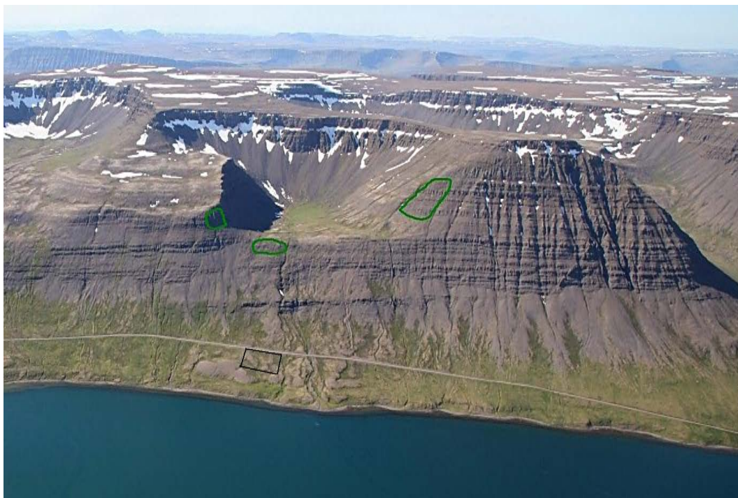
Ljósmynd 1. Reitur ætlaður fyrir vinnubúðir verktaka undir Haukshvilt í grennd við eyðibýlið Dranga í Dýrafirði. Möguleg upptakasvæði snjóflóða eru gróflega afmörkuð með grænum lit. Mynd: Vegagerðin.
